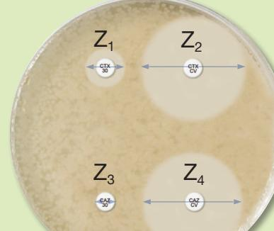
Z<sub>2</sub> - Z<sub>1</sub> ≥ 5mm and/or Z<sub>4</sub> - Z<sub>3</sub> ≥ 5mm
