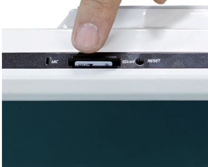
Kuva 27 SD-muistikortin poistaminen korttipaikasta
