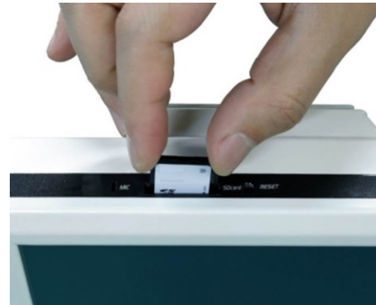
Kuva 28 SD-muistikortin asettaminen korttipaikkaan
