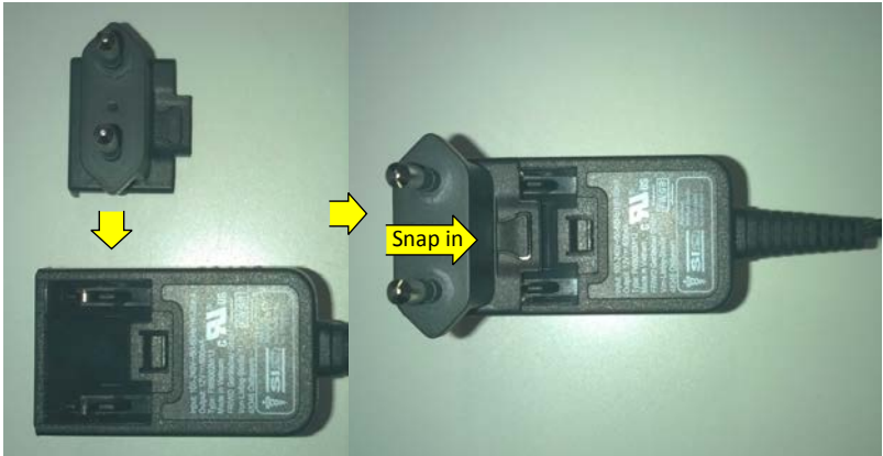
Latauslaitteen FW8002M/12 adapterin asennus
